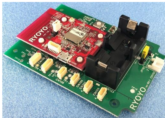
写真：菱洋エレクトロ開発 IoT システム PoC 用 Node Module
