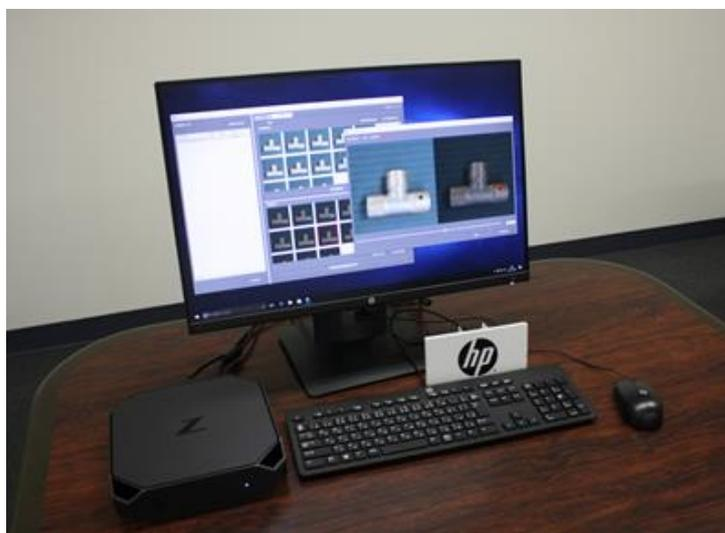
菱洋エレクトロでは、主に研究用途を対象として「gLupe」を NVIDIA 社の「Jetson™ TX1 開発キット」に搭載したモジュール型コンピュータを既にリリースしていますが、コマンドベースでの操作が必要であった従来の評価キットに対し、Windows ベースでの学習および評価が可能となった「Deep Learning 外観検査評価キット for Windows」は、より実用化に近い形で実証実験を行うことができる評価ツールとなっています。
